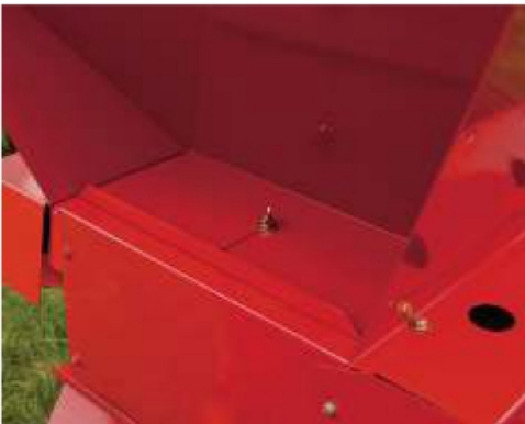
Заслонка регулирует объем подаваемого зерна для плющения.
