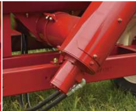
Гидромотор привода выгрузного шнека устанавливается в базовой комплектации на модели МЗВ-8.
