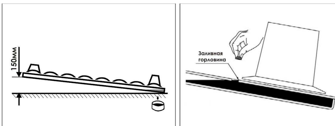
Рисунок 7.3 – Проверка уровня масла в режущем аппарате
