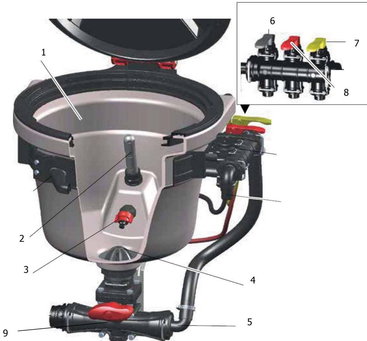
1 - Емкость 30 л; 2 – Форсунка для промывки тары; 3 - Форсунка перемешивания; 4 – Сетчатый фильтр; 5 – Эжектор; 6 - Кран промывки тары (черный); 7 - Кран промывки миксера (желтый); 8 – Кран перемешивания (красный); 9 - Кран опорожнения миксера
